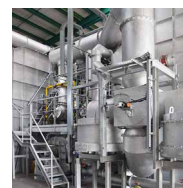
PulsReg®-Zentral Pulsierendes Regenerativ-Brennersystem
