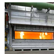
PulsReg®-Medusa Pulsierendes Regenerativ-Brennersystem
