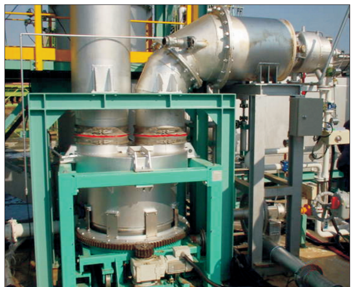
Bild 3: EcoReg®-Drehbettregenerator integriert im STAR-MEET System [4] Fig. 3: EcoReg® rotary bed regenerator integrated into the STAR-MEET system [4]
